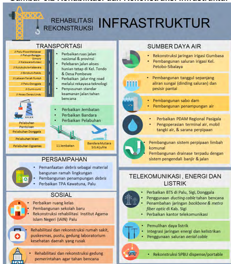
Gambar 6.2 Rehabilitasi dan Rekonstruksi Infrastruktur
